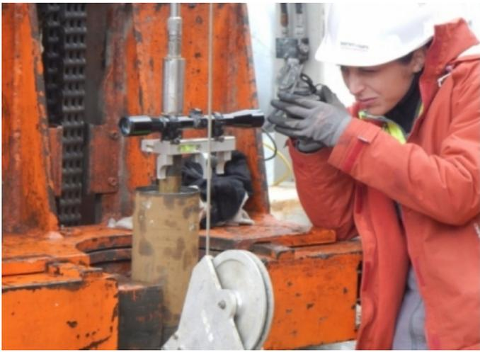
Orientation mesure gyroscopique
